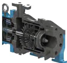
Petits et moyens débits, grandes hauteurs, sans pulsation, idéale pour les gaz liquifiés ou fluides en limite de tension de vapeur, comme les condensats, gaz réfrigérant, eau de chaudière, GPL.
