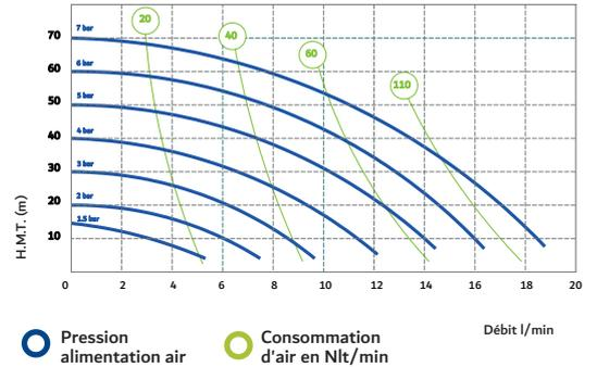
Les courbes et les prestations se réfèrent aux pompes avec aspiration immergée et refoulement à bouche libre, avec eau à 20° C, et varient selon le matériau de fabrication.
