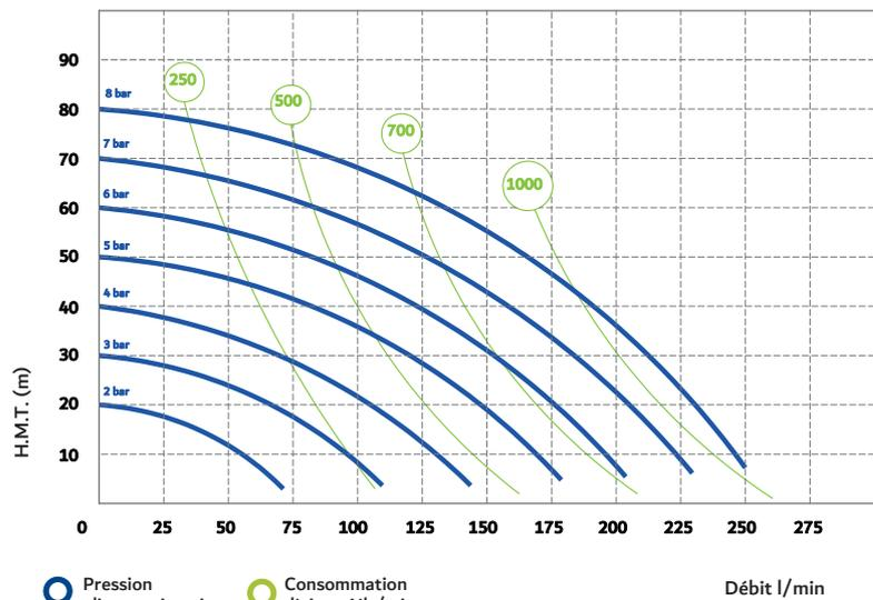
Les courbes et les prestations se réfèrent aux pompes avec aspiration immergée et refoulement à bouche libre, avec eau à 20° C, et varient selon le matériau de fabrication.
